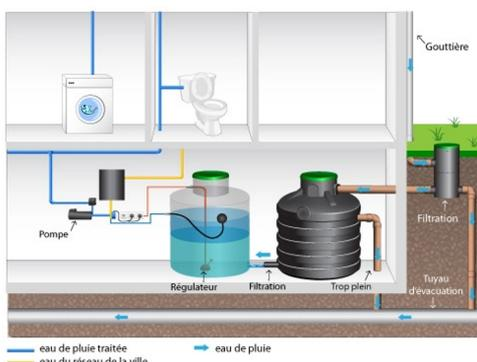
Pour les habitations sans jardin, elles devront être équipées d'un dispositif de stockage, filtration et remise en pression par pompage pour l'utilisation des toilettes, lave-linges ou tout autre usage non alimentaire. Cette installation devra être conforme à la réglementation MDR.
